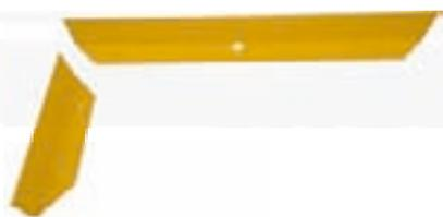
Zur Sicherung von Stützrahmen für Regale. Der neue Anfahrerschutz besitzt eine Neigbarkeit bis 15°. Somit werden Stöße von Staplern oder sonstigen Fahrzeugen abgefangen und die Dübelschraubverbindungen aus dem Beton im Hallenboden nicht herausgerissen oder beschädigt (Druck bis 400Nm).
