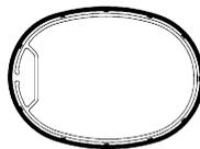
Mastprofil mit Bodenhülse. Profil 6,5 - 10 m.
