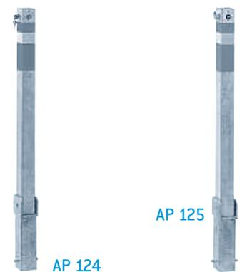
Feststehender Absperrpfosten aus Stahl, feuerverzinkt, Oberteil rot/weiß reflektierend, mit Bodenplatte zum Aufdübeln, 70 mm x 70 mm, Höhe über Flur 900 mm.
