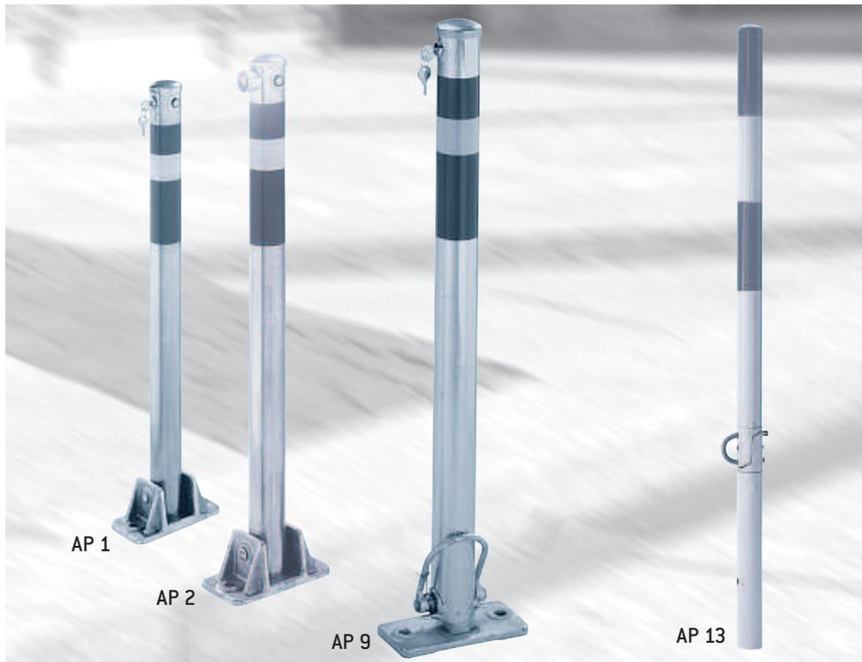
Absperrpfosten aus Stahl, feuerverzinkt, beidseitig umlegbar, Oberteil rot/weiß reflektierend, 64 mm ø, Höhe über Flur 900 mm.
