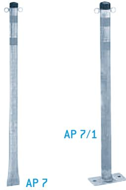
Feststehender Absperrpfosten aus Stahl, feuerverzinkt, Oberteil rot/weiß reflektierend, mit 2 Ösen, 60 mm ø, Höhe über Flur 1000 mm.
