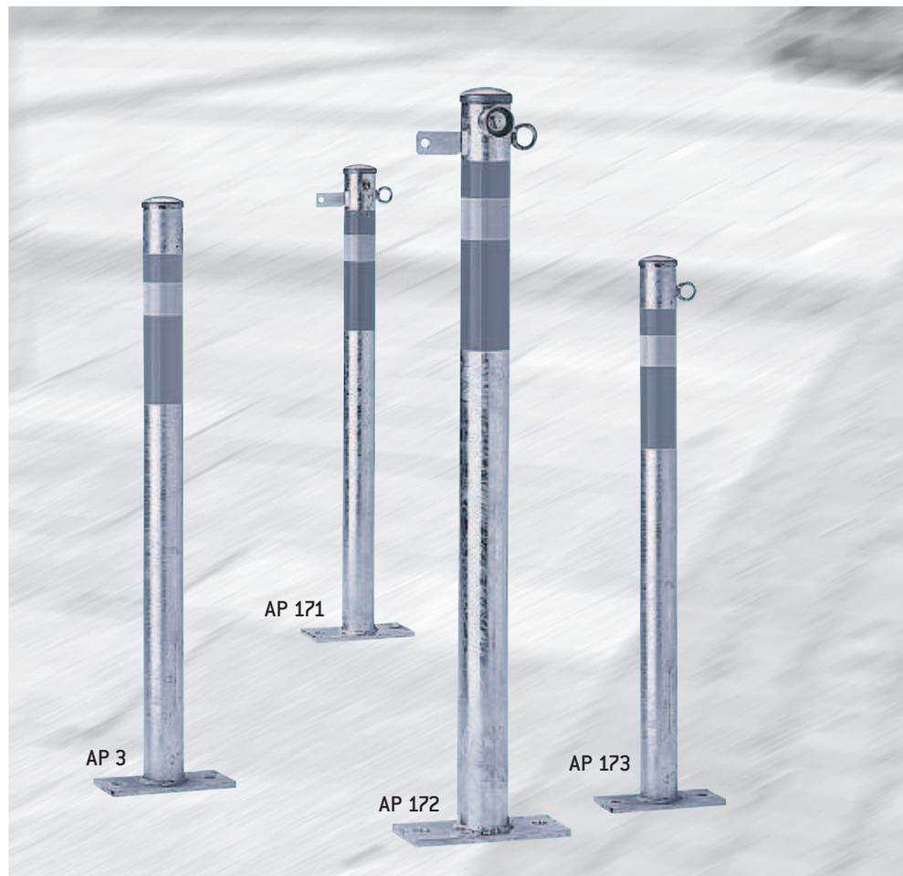
Feststehender Absperpfosten aus Stahl, feuerverzinkt, Oberteil rot/weiß reflektierend, mit Bodenplatte zum Aufdübeln, 64 mm ø, Höhe über Flur 900 mm.
