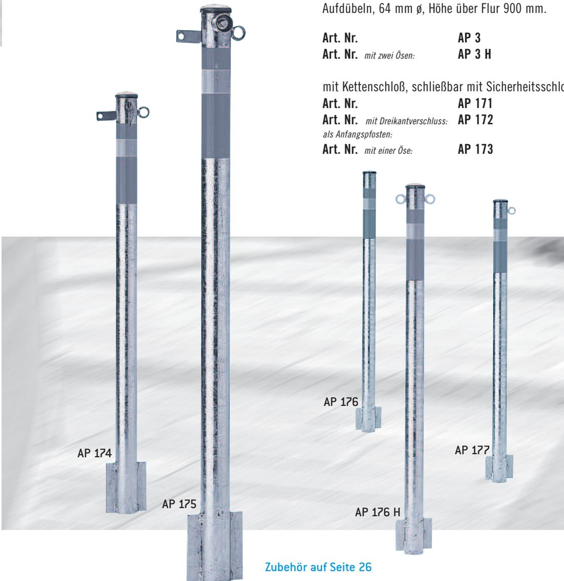
Feststehender Absperpfosten aus Stahl, feuerverzinkt, Oberteil rot/weiß reflektierend, mit Kettenschloß und Bodenanker, 64 mm ø, Höhe über Flur 900 mm.
