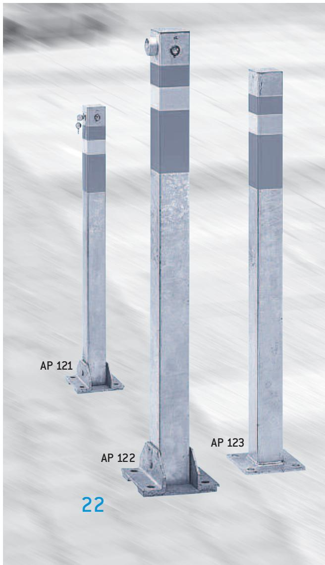
Umlegbarer Absperrpfosten aus Stahl, feuerverzinkt, Oberteil rot/weiß reflektierend, mit Bodenplatte zum Aufdübeln, 70 mm x 70 mm, Höhe über Flur 900mm.
