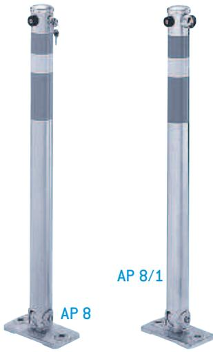
Umlegbarer Absperpfosten aus Stahl, feuerverzinkt, Oberteil rot/weiß reflektierend, mit Bodenplatte zum Aufdübeln, 64 mm ø, Höhe über Flur 900 mm.
