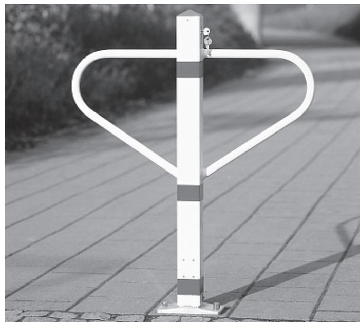
Absperrrpfosten aus Stahl, feuerverzinkt, mit roter Reflexfolie, als Durchgangssperre, Absperrbreite 770 mm, 70 x 70 mm, Höhe über Flur 900 mm.
