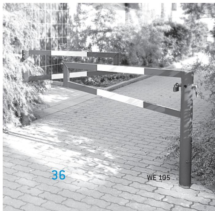
Gatterschränke zweiseitig aus Stahl, rot/weiß lackiert, zum fest Einbetonieren, abschließbar mit Verschlussbolzen für bauseitiges Vorhängeschloss, Drehpfosten 100 mm  $\phi$ , Höhe über Flur 1000 mm, Schrankenbaum 60 x 30 mm.
